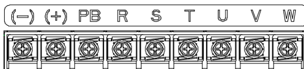
Рис 4.10 Клеммы силовых цепей 380 В 30-37 кВт
